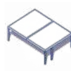
Techo doble con poste de puerta
